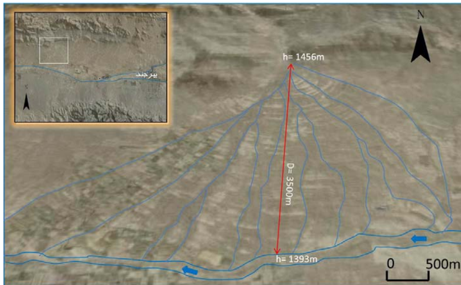
شکل شماره ۳: شیب عمومی (۱.۸ درصد) دامنه محل استقرار بند سارها در جنوب بیرجند- تصویر کوچک بخش جنوبی دشت بیرجند - خوسف و مستطیل سفید محدوده تصویر اصلی - تصویر تلفیق DEM و تصاویر ماخذ از سایت گوگل ارث
