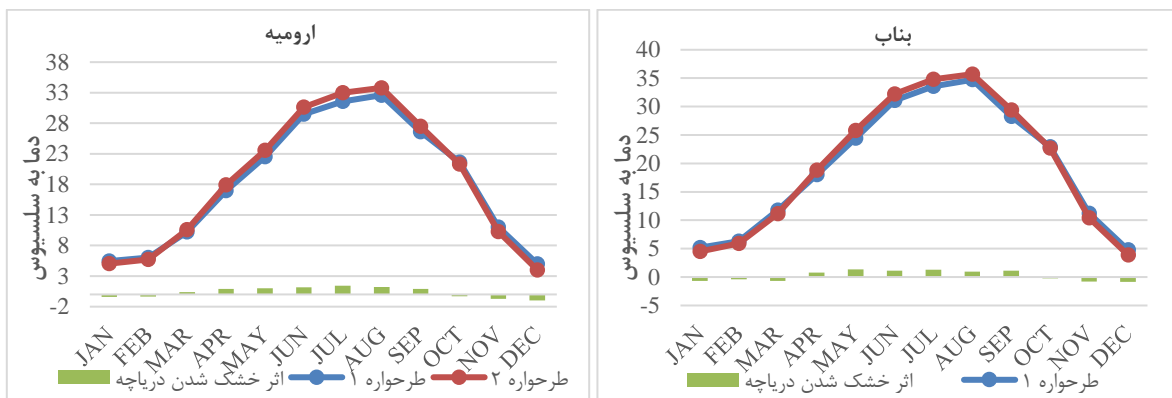
شکل ۸: نتایج شبیه‌سازی مدل TAPM برای فراسنج دمای بیشینه در دو طرح‌واره‌ی ۱ و ۲ (نمودار خطی) و میزان اختلاف دما در دو طرح‌واره مذکور (نمودار ستونی) در میانگین دو سال ۲۰۰۳ و ۲۰۰۶.
