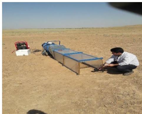
شکل ۴: اندازه‌گیری سرعت آستانه‌ی فرسایش بادی دستگاه تونل باد
