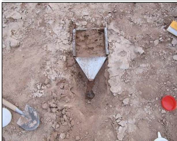
شکل ۳: (بالا و پایین) نمایی از شبیه‌ساز باران مورد استفاده و ابعاد آن (۲۵*۲۵ سانتی‌متر)، (راست) اندازه‌گیری عمق نفوذ آب بارش در خاک
